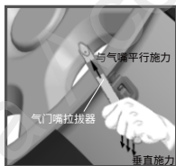
3. 使用气门嘴拉拔器 安装传感器总成
